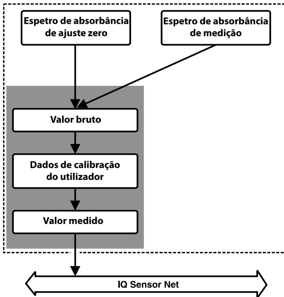
figura 4-1 Determinação dos valores medidos
