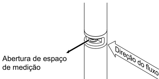
*figura 3-2 Instalação vertical*
